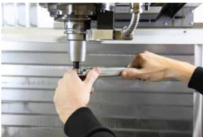
Pour serrer l'outil de façon optimale et sans à coups, il est conseillé de maintenir la tête de fraisage, lorsque l'on procède au serrage.
