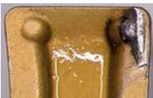
Les copeaux, dont la température est excessive, viennent éroder la face de coupe de la plaquette.
