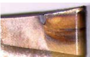
Erosion de l'arête.
