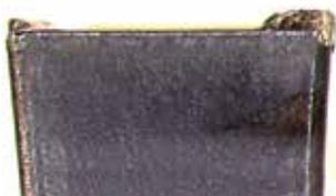
Conglomérat de matière sur l'arête, dû à une température de coupe trop faible.
