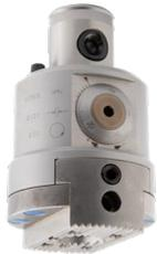
Le système hi.flex se caractérise par une haute flexibilité et le recouvrement d'une large plage de diamètres de 6 à 365 mm avec une seule tête d'alésage, différentes barres d'alésage et adaptateurs.
