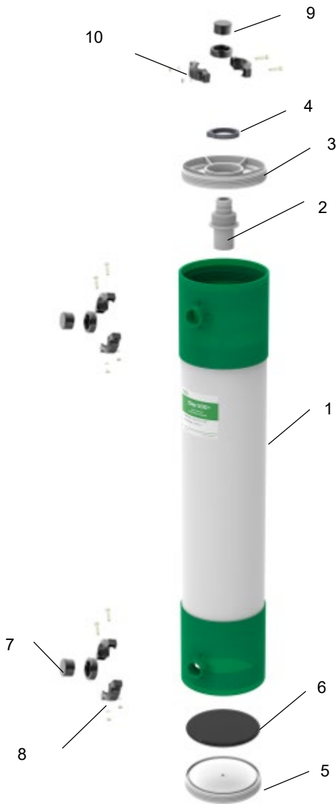
Figure 7. iSep UF module assembly
