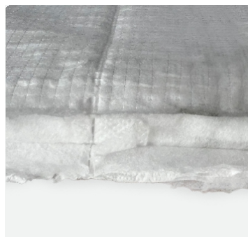
Exemple de poche non cousue d'un concurrent qui entraîne la rupture et la migration des fibres.
