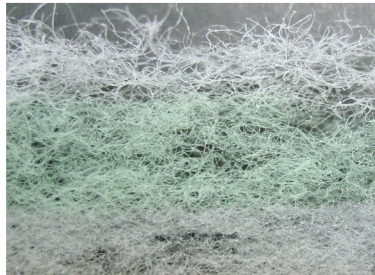
Coupe transversale du média à densité progressive Tri-Dek. Le flux d'air circule de haut en bas.
