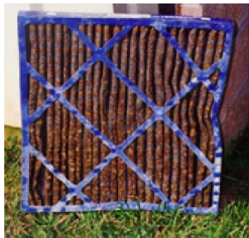
Exemple de dégâts dus à l'humidité et à la croissance microbienne
