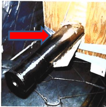
Beispiel: Beschleunigungskräfte werden oft unterschätzt. Hier durchschlägt ein nicht ausreichend gesicherter Zylinder die Kistenwand. Quelle: HPE
