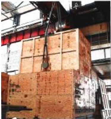
Beispiel: Mitgenommene Verpackung mit Sperrholzverschalung
