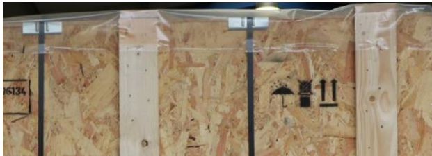
Beispiel: Kantenschutz außen
