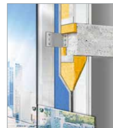
Αεριζόμενη πρόσοψη με υαλοπίνακες
