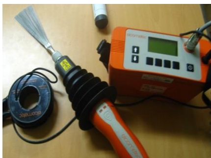
100% Porenprüfung der Beschichtung, gem. ISO 2746 (ASTM D 5162)
