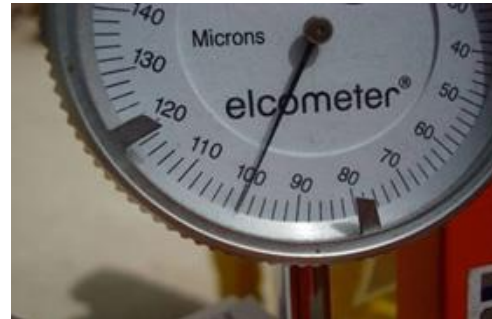
Rauheitsmessung Rz 100 µm, mit „Testex Press-O-Film Kit“ gem. ISO 8503-3
