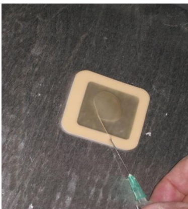
Bresle-Testpflaster mit Injizierung von Entionisiertes Wasser
