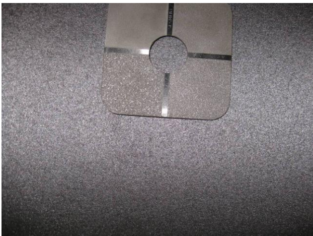
Reinheitsgrad, nach Sa 2½, R_z 40-60 \mu m ISO 8503-1
