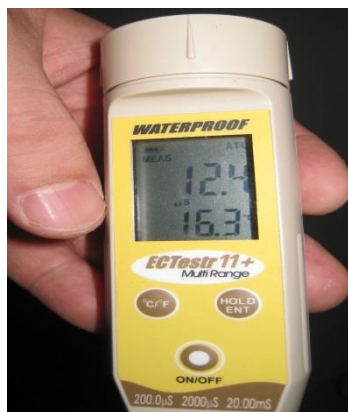
Leitfähigkeitsmessgerät Messergebnis: 12,4 mg/m 2 (NaCl)
