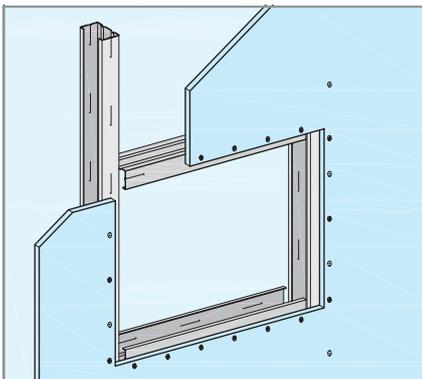
Varijanta 1: 2 komada CW pro la za montažu između postojećih okomitih montažnih pro la izrežite na potrebnu duljinu (cca. 10 mm kraće od svijetlog razmaka između okomitih montažnih pro la) te sredinu prirubnice na rubu otvora vijcima spojite s oblogom (samourezni TN vijci, razmak: cca. 100 mm).
