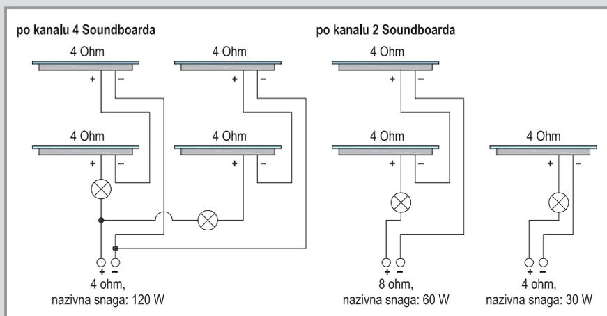
**Napomena:** (Da bi rizik od kvarova uslijed preopterećenja bio sveden na minimum, preporuča se ugradnja sofitnih žarulja (24 V, 18 W) (nije 100 %-tna zaštita, instalirati da bude pristupačno).
