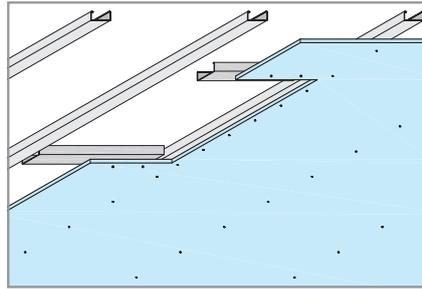
Za montažu Soundboarda između nosivih pro la, poprečne pro le CD 60x27 izrežite na potrebnu duljinu (cca. 10 mm manje od svijetlog razmaka između nosivih pro la) te os pro la na sredini ruba otvora vijcima spojite s oblogom (samourezni TN vijci, razmak: cca. 100 mm).
