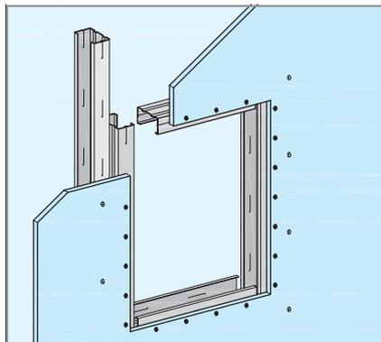
Varijanta 2: 4 komada CW pro la za montažu izrežite na potrebnu duljinu te sredinu prirubnice na rubovima otvora vijcima spojite s oblogom (samourezni TN vijci, razmak: cca. 100 mm).
