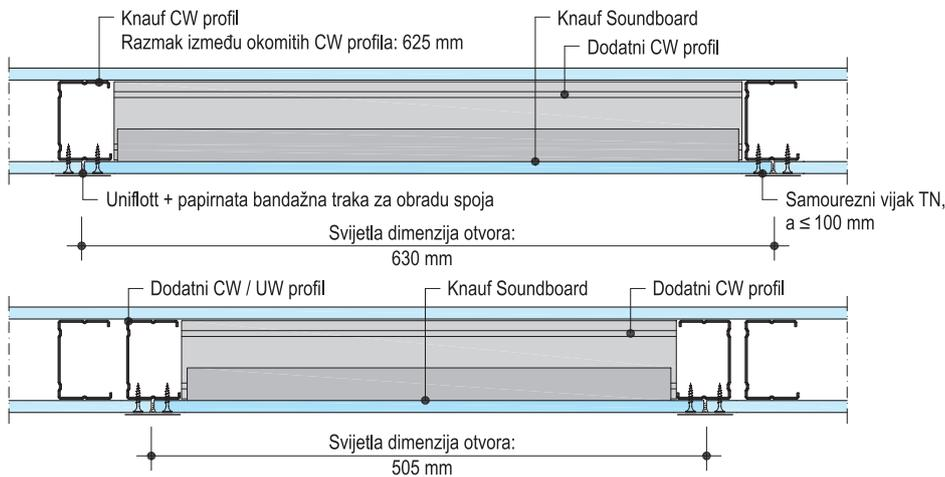
Izvedba za dvostruko obloženi spuštenu strop
