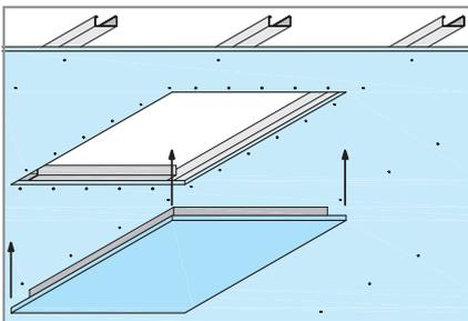
Soundboard po sredini umetnite u otvor (okolna fuga širine 2-3 mm) i Knauf samoureznim TN vijcima spojite na okolne pro le u razmaku od cca. 100 mm.
