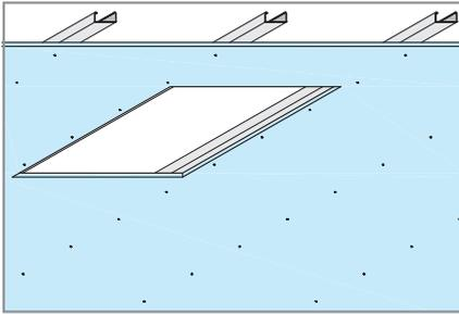
Otvor u dimenzijama 630 mm x 505 mm (otvor po duljini i širini za 2,5 mm veći od Soundboarda) izvesti u postojećoj ili novoj oblozi.
