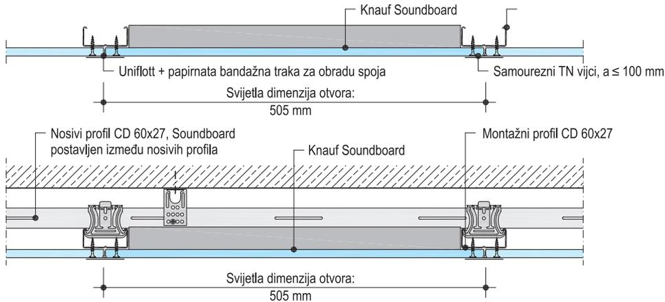
Izvedba za dvostruko obloženi spuštenu strop
