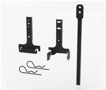
Noniuspendel C5 Används för nedpendlade undertak som kan utsättas för vindlast. C5 noniuspendel, underdel 40 kg, skruvas fast i CD profilen.
