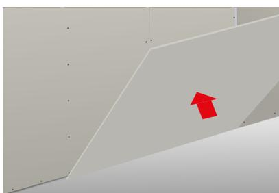
Le type d'ossature métallique et la section du profilé ainsi que leur entraxe seront fonction de la hauteur du local, le revêtement ultérieur et des performances thermiques visées. Le vide entre l'ossature métallique et la paroi existante se fera en fonction des performances d'isolation souhaitées ainsi que la présence d'éléments techniques.
