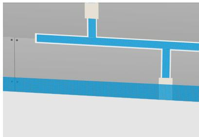
Les caractéristiques de l'ossature (type et entraxe) seront fonction de l'épaisseur d'isolant à mettre en œuvre, du type de finition, du poids propre des divers éléments, des charges extérieures appliquées (p.ex vent), ...
