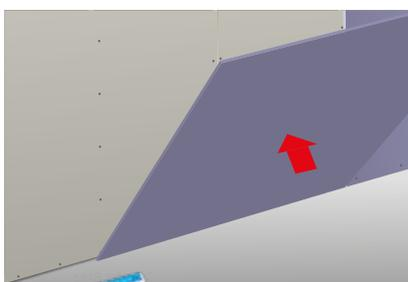
Le type de sous-structure métallique (simple ou double ossature) et la section du profilé ainsi que leur entraxe seront fonction de la hauteur du local, du revêtement ultérieure des performances acoustiques visées ainsi que la présence de raccords sanitaires.
