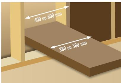
Insérer l'isolant Naturoll 032 ou 035 entre les montants de l'ossature.
