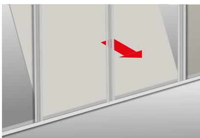
Insérer les panneaux isolation Acoustifit ou Rock4All entre les montants. Veiller à bien combler le vide entre les profilés et éviter la formation de joints préjudiciable aux exigences acoustiques.
