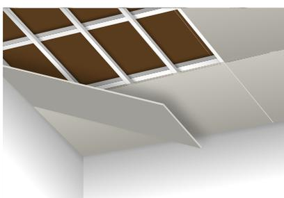
Les plafonds autoportants (plafonds Knauf D110), permettant une désolidarisation totale vis-à-vis du plancher supérieur, ne sont pas traités au sein de cette brochure. Le type de profilé Knauf CW/UW sera fonction de la portée à franchir (profilés Knauf CW disposés suivant la plus petite longueur à franchir) ainsi que de la composition du plafond (isolation, type de parachèvement).
