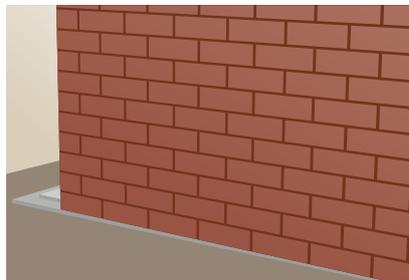
Eriger en premier lieu la paroi intérieure afin d'éliminer toutes bavures ou excédents de mortier. Une surface plane facilitera la pose de l'isolant et évitera une formation d'une lame d'air entre l'isolant et la paroi intérieure. Veiller à ce que celle-ci soit parfaitement étanche à l'air.
