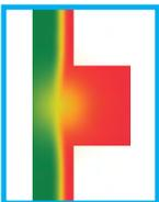
A incorporação do elemento de fachada ventilada permite criar uma capa de isolamento uniforme que **elimina as pontes térmicas de frentes de laje ou pilares.**
