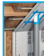
O sistema incorpora membranas herméticas ao ar interior e fitas de vedação para evitar as exfiltrações e infiltrações.
