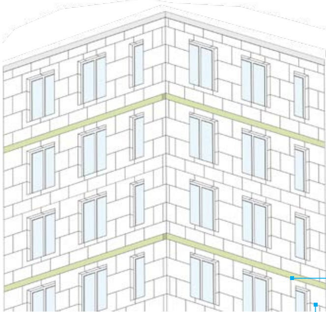
Umlaufender Brandschutzriegel über jedem zweiten Geschoss
