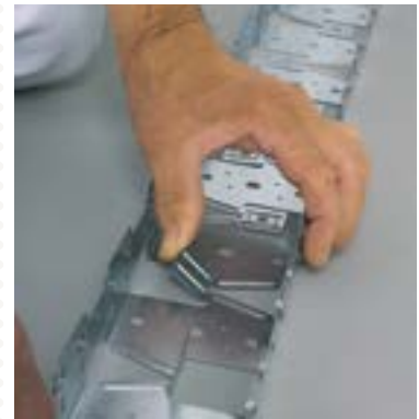
Waar de lippen haaks omhoog worden gebogen wordt het Sinus profiel flexibel.
