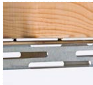
De Knauf Veeerregel wordt per balk met twee snelbouwschroeven bevestigd en daarbij 1 mm los gehouden.
