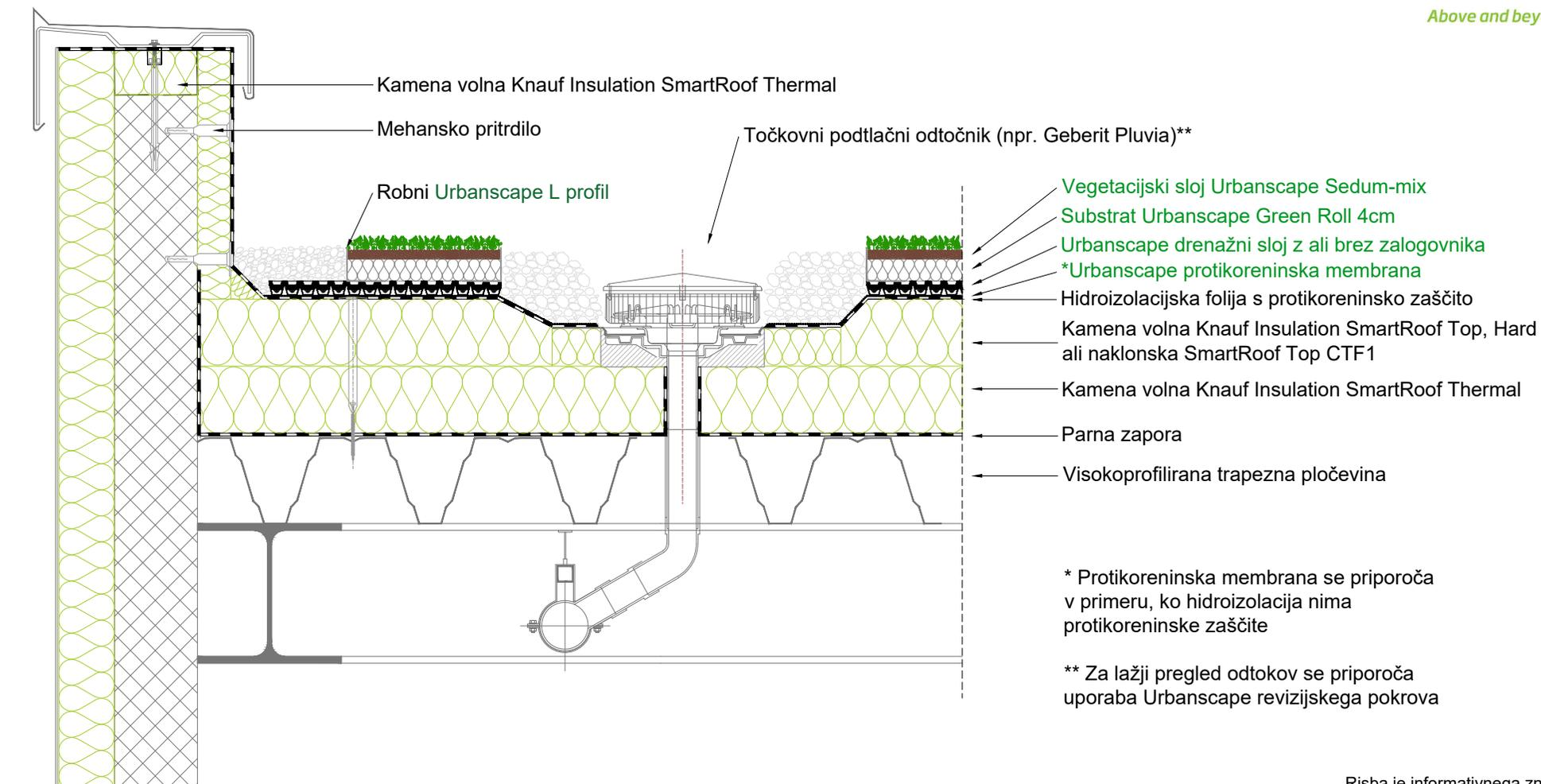
\* Protikoreninska membrana se priporoča v primeru, ko hidroizolacija nima protikoreninske zaščite
