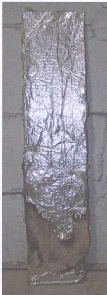
Рисунок 1 - Характерний вигляд зразка теплоізоляційного матеріалу на основі мінеральної вати на синтетичному вяжучому марки Knauf Insulation LM Eco Alu, виробництва «Knauf Insulation» d.o.o» (Хорватія), після випробувань з визначення групи горючості згідно з ДСТУ Б В.2.7-19-95.
