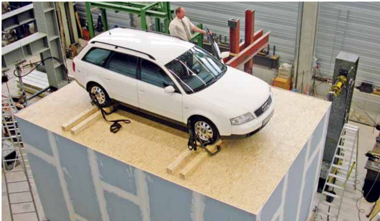
Fig. 3.20: Visual loading test of system Cubo /Knauf Gips KG/
