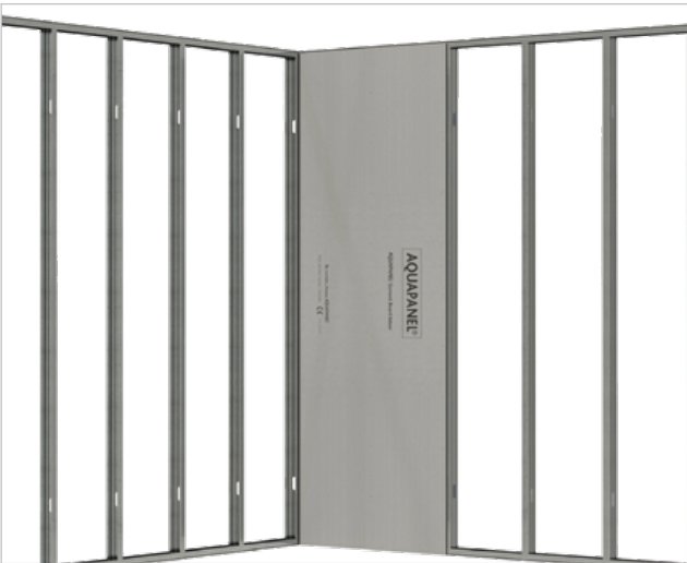
Stående montage, regelstomme s450 mm. Skiva: 900 x 1200, 900 x 2400 eller 900 x 2500.
