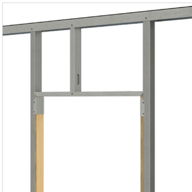
Exempel på uppklippt skena med sidoflänsar på min. 100 mm.
