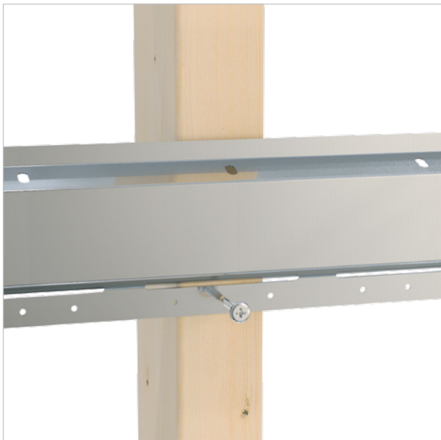
Fäst Akustikprofil AP till stommen genom de förborrade hålen. Detta säkerställer att profilen förblir fjädrande efter skivmontaget.
