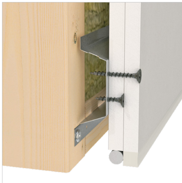
Akustikprofilen närmast golvet monteras så att den kan skruvas till syll. Gipsskivorna monteras med ett avstånd på minst 10 mm till golvet*. Spalten tätas med elastisk fogmassa, sockellist bör limmas mot gipsskivorna. Om gipsskivorna ställs mot golvet försämras ljudisoleringen kraftigt.
