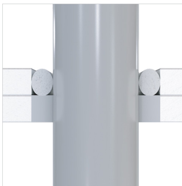
Ljudtätning kring VP-rör med fogmassa och botteningslist.
