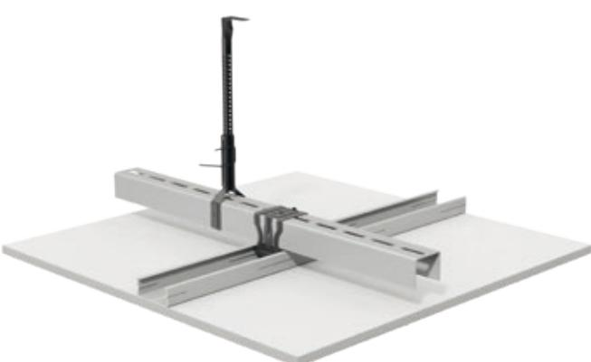
Οι γυψοσανίδες Knauf βιδώνονται σε μεταλλικό σκελετό στήριξης που αποτελείται από κύριους οδηγούς UA 50 και δευτερεύοντες οδηγούς από μεταλλικά προφίλ CD 60/27. Η στερέωση του σκελετού στήριξης γίνεται με αναρτήσεις στη φέρουσα οροφή. Με αυτό το σύστημα μπορούν να κατασκευαστούν οροφές με μεγάλες αποστάσεις μεταξύ των αναρτήσεων π.χ. σε πυκνές εγκαταστάσεις στο διάκενο οροφών, ή σε μεγάλες αποστάσεις φερόντων στοιχείων.
