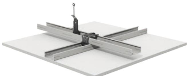
Οι γυψοσανίδες Knauf βιδώνονται σε μεταλλικό σκελετό στήριξης που αποτελείται είτε από κύριους και δευτερεύοντες οδηγούς (ανισόπεδος σκελετός) είτε από δευτερεύοντες οδηγούς (μονός σκελετός) από μεταλλικά προφίλ CD 60/27 ή προφίλ Ω. Η στερέωση του σκελετού στήριξης γίνεται με αναρτήσεις ή άμεσα με κατάλληλα μέσα στερέωσης στη φέρουσα οροφή. Η στερέωση των CD-προφίλ στη φέρουσα οροφή γίνεται με αναρτήσεις, τα προφίλ Ω στερέωνται με άμεσο τρόπο.
