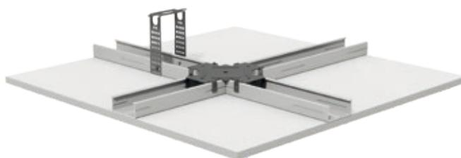
Οι γυψοσανίδες Knauf βιδώνονται σε μεταλλικό σκελετό στήριξης που αποτελείται από κύριους και δευτερεύοντες οδηγούς από μεταλλικά προφίλ CD 60/27 που συνδέονται μεταξύ τους ισόπεδα. Η στερέωση του σκελετού στήριξης γίνεται με αναρτήσεις στη φέρουσα οροφή. Με αυτό το σύστημα μπορούν να πραγματοποιηθούν οροφές σε μικρά ύψη ανάρτησης και γίνεται ευκολότερη η τοποθέτηση σε όλη την επιφάνεια μιας ενδεχόμενης μονωτικής στρώσης.
