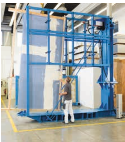
Προετοιμασία διάταξης δοκιμών για μετρήσεις οριζόντιων διατμητικών φορτίων σε τοιχοποιία
