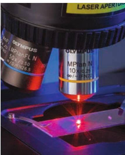
Αντίστροφη μικρο-Raman φασματοσκοπία για τον καθορισμό της χημικής σύστασης
