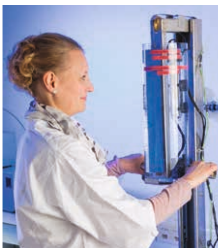
Δοκιμή υγρού εφελκυσμού του χαρτιού
