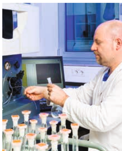
Ανάλυση στοιχείων σε υγρά δείγματα με τη χρήση της μεθόδου ICP-OES
