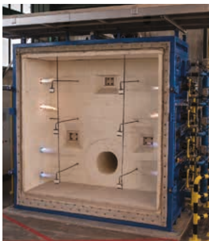
Δοκιμή πυραντοχής σε διάταξη για τοιχοποιία διαστάσεων 3 x 3 m
