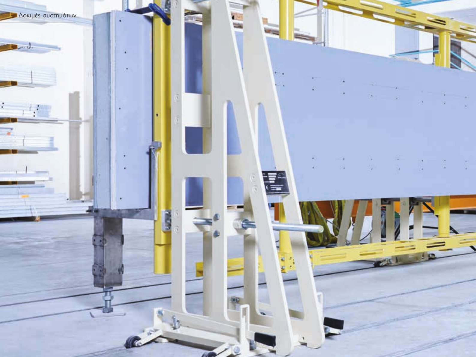
Έλεγχος τοιχοποιίας σε οριζόντια θέση
