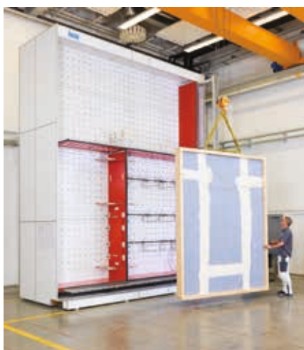
Εγκατάσταση δοκιμίου σε διάταξη δοκιμών για προσόψεις
