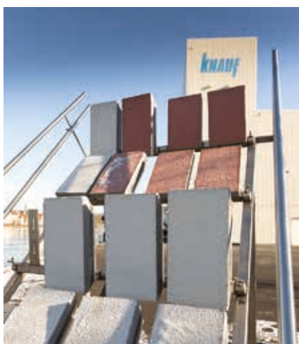
Διάταξη ελέγχου έκθεσης των προϊόντων προσόψεως στις εξωτερικές καιρικές συνθήκες
