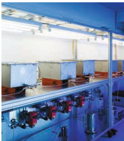
Εξοπλισμός μετρήσεων για τον καθορισμό της απορρόφησης ή της φωτοκατάλυσης των οργανικών χημικών ενώσεων των υλικών κατασκευής
