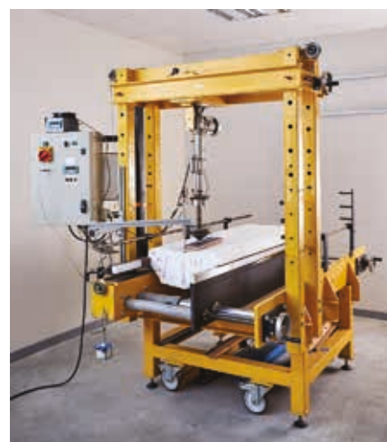
Δοκιμή στρέψης στοιχείων οροφής σε εισαγμένο δοκίμιο
