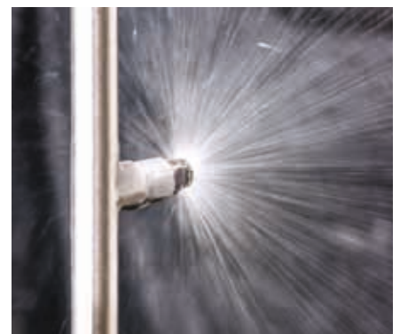
Εφύγγραση προσόψεων σε υγροθερμικό εργαστήριο ελέγχου
