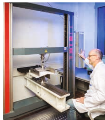
Δοκιμή θραύσης τεσσάρων σημείων σε αρμό γυψοσανίδας
