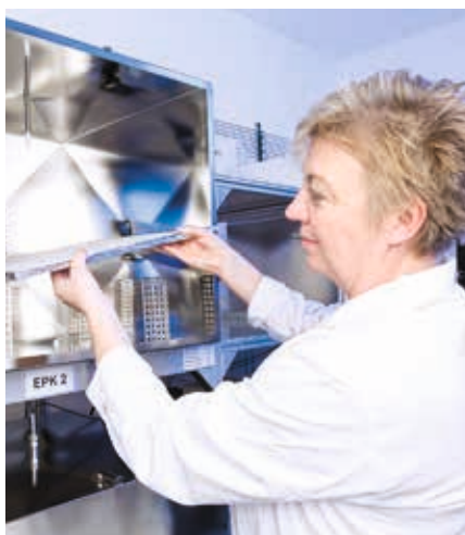
Καθορισμός εκπομπών των δομικών υλικών
