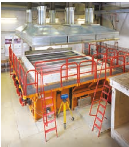
Δοκιμή πυραντοχής σε διάταξη για οροφή διαστάσεων 4 x 4 m
