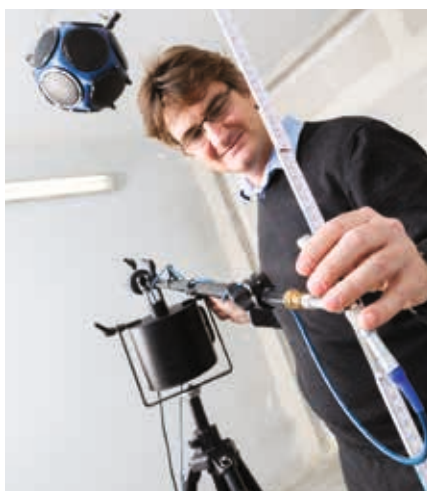
Τοποθέτηση εξοπλισμού μετρήσεων σε διάταξη ελέγχου τοιχοποιίας
