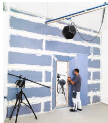
Τοποθέτηση οργάνων για δοκιμές ακουστικής σε διάταξη μέτρησης ιδιοσυχνοτήτων
