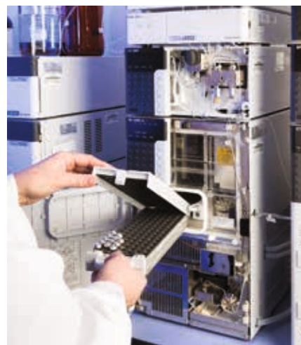
Εξέταση δειγμάτων με τη χρήση ανοιχτής, υψηλής απόδοσης, υγρής χρωματογραφίας (HPLC)
