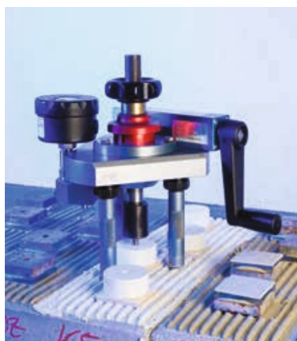
Μέτρηση δύναμης συγκόλλησης των κολλών πλακιδίων
