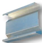
Profilé primaire en acier galvanisé, protégé contre la corrosion par galvanisation à chaud répondant aux spécifications de la norme NF EN 10327. Leur section et leur épaisseur est variable en fonction de la hauteur de l'ouvrage à réaliser, des charges et des effets du vent. Dimensions disponibles en stock : 120, 140, 170 et 200 mm en longueur 6,50 m.
