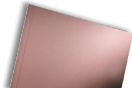
Knauf KF Feu est une plaque dont la résistance au feu a été renforcée par l'incorporation de vermiculite et de fibre de verre. Elle permet de réaliser des ouvrages à la résistance au feu améliorée, faisant l'objet systématiquement de PV d'essais.
