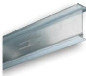
Profilé renforcé en acier galvanisé destiné à des plafonds. Associé obligatoirement à une ossature secondaire F47, FL 55, CD 60, MOB ou F60 Oméga dans laquelle les plaques sont vissées.
