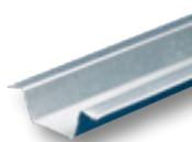
Profilé secondaire en acier galvanisé, protégé contre la corrosion par galvanisation à chaud répondant aux spécifications de la norme NF EN 10327, en forme d'oméga. Ils sont fixés perpendiculairement par 2 vis autoperceuses sur chaque profilé PK. Largeur hors tout 100 mm (surface d'appui 52 mm), hauteur 31 mm, longueur 4 050 mm et épaisseur 0,63 mm.
