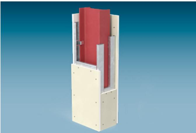
Das System **K253.at** Knauf Fireboard Stahlstützen-Bekleidung wird mit Metall-Unterkonstruktion und geschraubter Beplankung oder ohne Metall-Unterkonstruktion und mit geklammerter Beplankung ausgeführt. Alternativ zur stirnseitigen Verklammerung ist die Verschraubung Platte in Platte mit Würth ASSY® plus 4 P Senkfräskopf 60° 3,5x60 mm zulässig.
