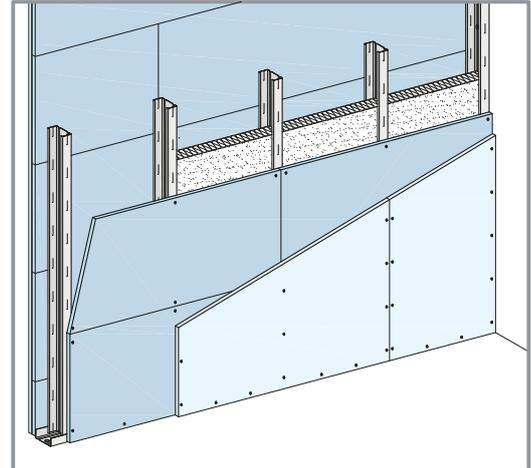
Bleigleichwerte für Vorzugslösung Strahlenschutzwand "Safeboard 1,0"
