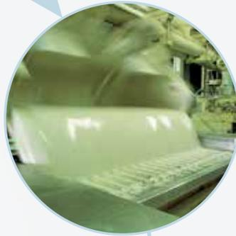
Le plâtre est mélangé à l'eau jusqu'à l'obtention d'une masse homogène. Les additifs éventuels, qui déterminent le type de bloc, sont incorporés lors de cette phase. Le mélange durcit ensuite dans un châssis de moulage.
