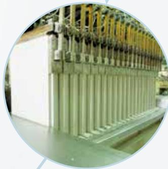
Avant que ce processus de durcissement ne s'achève, les blocs de plâtre sont extraits de la matrice à l'aide de pinces.
