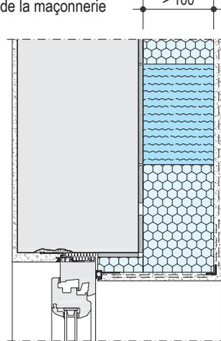
Châssis de fenêtre en applique ou partiellement dans la couche d'isolant
