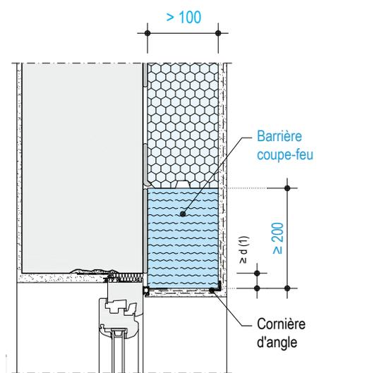
Châssis de fenêtre au milieu de la maçonnerie
