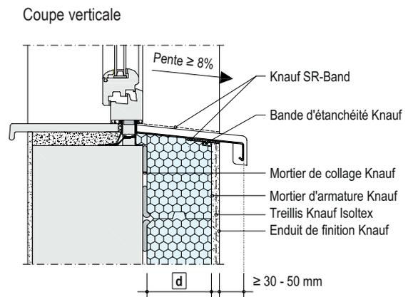
**P322.be-FE-H3 Châssis en dehors du plan de la maçonnerie**
