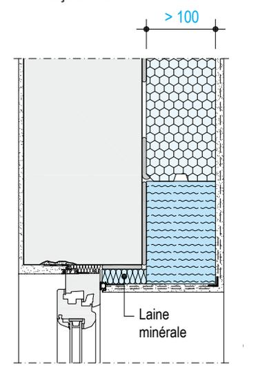
Châssis de fenêtre en applique ou partiellement dans la couche d'isolant
