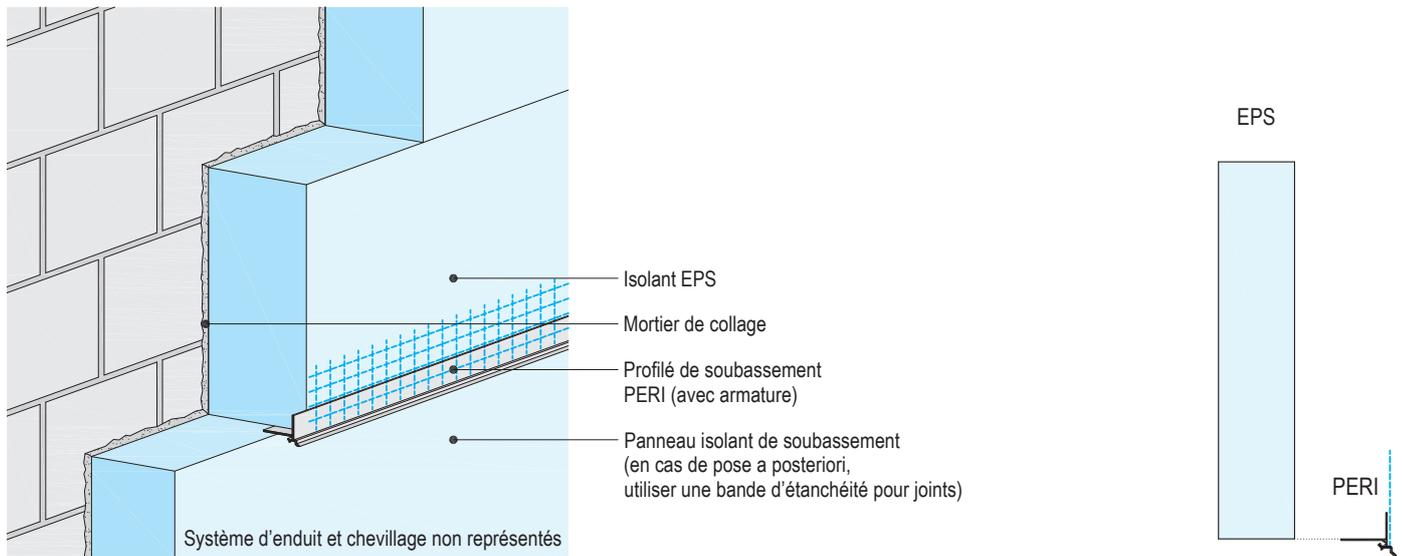
Appliquer le mortier d'armature sur le panneau isolant de façade, insérer le profilé de soubassement PERI entre l'isolation périphérique/de soubassement et l'isolation de la façade, le presser dans le mortier d'armature, l'aligner et insérer le treillis d'armature.
