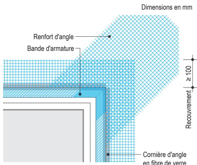
*Insérer également aux angles de toutes les ouvertures un morceau d'armature en diagonale sous forme de flèche (Renfort d'angle) ou une bande d'armature d'env. 300 x 500 mm.*
