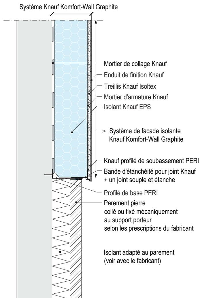
Schéma de principe
