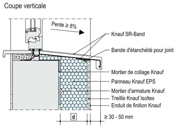
**P322.be-FE-H2 Châssis affleurant au plan de la maçonnerie**
