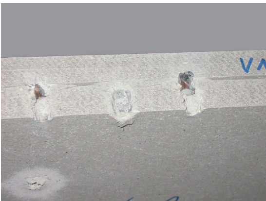
Testobject na de kogelinslagtest.
