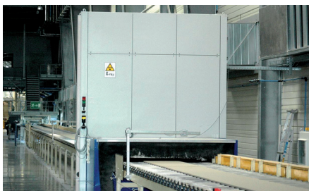
Controle van de productie met de röntgen-scanner.
