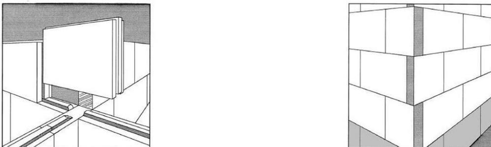
Figure 4a : Gaine réalisée avec des blocs de plâtre
