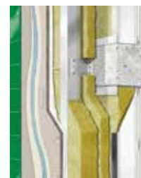
Dvostruka potkonstrukcija s kontinuirano postavljenim profilima
