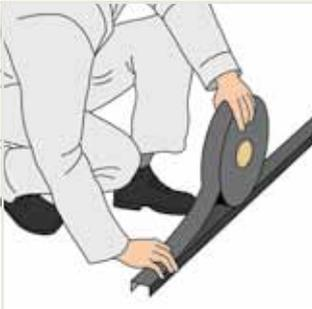
Der einfache dichte Anschluss der Dampfbremsbahn an Decke/Boden erfolgt durch einen ca. 1,5cm breiten Streifen Dampfbremsbahn der mit Knauf Soliplan auf dem Trennstreifen fixiert wird.
