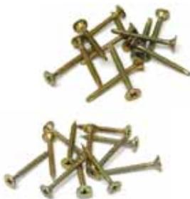
AQUAPANEL® Maxi Schrauben sind speziell für die Befestigung von AQUAPANEL® Cement Board Indoor auf Holz- und Metal-Unterkonstruktionen mit unterschiedlichen Dicken entwickelt worden. Beide Versionen mit Nagelspitze und Bohrspitze besitzen einen Senkkopf. AQUAPANEL® Maxi Schrauben können für Wand und Decke im Innen- wie Außenbereich verwendet werden.
