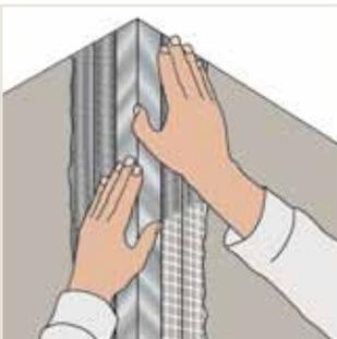
Die Außenecken werden mit Hilfe von PVC-Gewebeeckprofilen verstärkt, die direkt auf der AQUAPANEL® Cement Board Outdoor mit dem AQUAPANEL® Fugenspachtel – grau oder AQUAPANEL® Klebe- und Armiermörtel – weiß fixiert werden.
