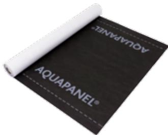
AQUAPANEL® Water Barrier ist eine hochdiffusionsoffene, regensichere und winddichte Membran. Sie wird als wasserführende Ebene bei direkt beplankten Systemen hinter AQUAPANEL® Cement Board Outdoor eingesetzt und verhindert, dass Wasser, welches hinter die Platte gelangt, weiter in die Wand vordringt.
