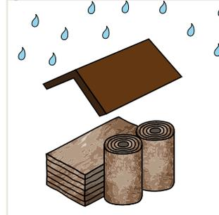
Dämmmaterialien werden in einer Folie geliefert, die nur dem kurzfristigen Schutz dient. Zur längeren Aufbewahrung auf der Baustelle sollte das Produkt entweder im Innenbereich oder abgedeckt und nicht auf dem Boden gelagert werden. Die Produkte sollten nicht dauerhaft der Witterung ausgesetzt sein.
