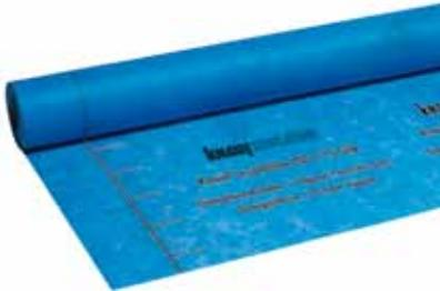
Dampfbremsbahn aus Polypropylen-Spinnvlies; LDS 10 ist alterungsbeständig und reißfest (sd-Wert 10m). Entspricht EN 13984 und ETAG 007.
