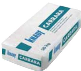
Mineralischer Edelputz zur Herstellung vielfältig strukturierter oder verbürsteter Oberflächen, z. B. als Kellenstrichputz, Altdeutscher Putz oder verwaschener und verbürsteter Putz. Carrara 3-5 mm mit Kelle oder Traufel auftragen, frei strukturieren und ggf. anschließend mit Schwamm oder Bürste bearbeiten. Weitere Informationen können dem technischen Blatt P563.de entnommen werden.
