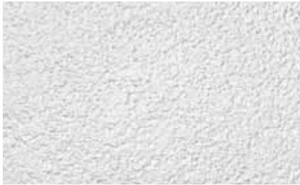
Für die Putzstruktur eines Knauf Scheibenputzes wird ein Mörtel mit gebrochenem Strukturkorn mit einer Glättkelle aufgetragen, auf Kornstärke abgezogen und gerieben. Das Ergebnis ist eine verschmutzungsarme, ausgeprägte Struktur, die – je nach Korngröße – eine unterschiedliche Optik erzielt.
