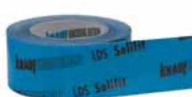
Armirtes Haftklebeband auf Polyethylen-Basis zum elastischen Andichten der Dampfbremsbahnen und Luftdichtheitsschichten im Bereich von Durchdringungen. Alterungsbeständig.
