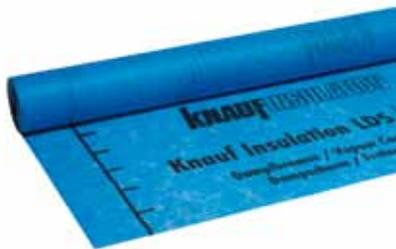
Dampfbremsbahn aus Polypropylen-Spinnvlies; LDS 2 Silk ist alterungsbeständig und reißfest (sd-Wert 2m). Entspricht EN 13984 und ETAG 007.
