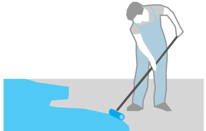
Grundierung mit z. B. Knauf Estrichgrund (siehe F42.de). Auftrag mit Rolle. Verbrauch: ca. 200 g/m<sup>2</sup>.
