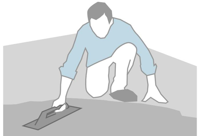
Verbrauch: Knauf N 410 ca. 1,6 kg/m<sup>2</sup>/mm Schichtdicke. Anschließend grundieren.
