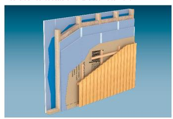
Das Holztafelbau-Außenwandsystem **W551S.de** ist beidseitig mit zwei Lagen 18 mm Knauf Diamant X / SX beplankt.
