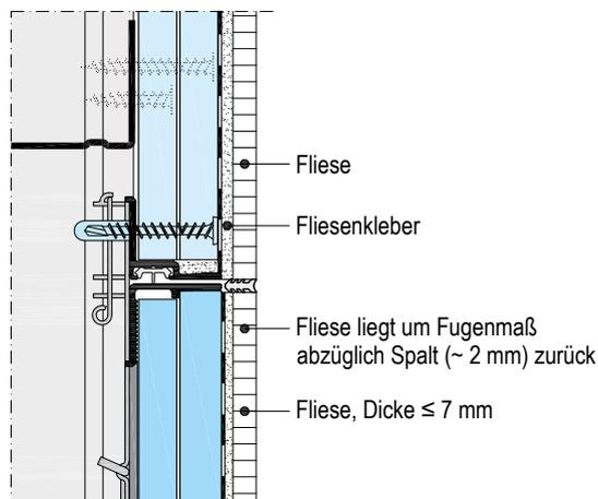
Außenrahmen einstellen, ausrichten und festsetzen (**ACHTUNG:** Innenmaß lichter Durchgang umlaufend kontrollieren). Einbau Revisionsklappe laut beiliegender Montageanleitung. Die Wandbefliesung liegt auf dem Außenrahmen auf und schließt bündig mit dem lichten Durchgang ab.
