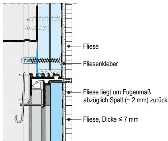
Außenrahmen einstellen, ausrichten und festsetzen (**ACHTUNG:** Innenmaß lichter Durchgang umlaufend kontrollieren). Einbau Revisionsklappe laut beiliegender Montageanleitung. Die Wandbefliesung liegt auf dem Außenrahmen auf und schließt bündig mit dem vorderen lichten Durchgang ab.
