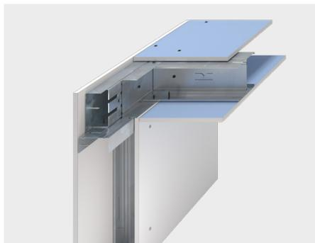
2. Deckenoberseitige Beplankung quer zu CW-/UA-Doppelprofilen verlegen. Befestigung der Platten in Plattenmitte oder an Plattenecke beginnen, um Stauchungen zu vermeiden. Platten bei Verschraubung fest auf die Unterkonstruktion drücken und mit Schnellbauschrauben/Diamantschrauben alternierend an den CW-/UA-Doppelprofilen befestigen. (Bei Holzwerkstoffplatte HWP vorbohren).
