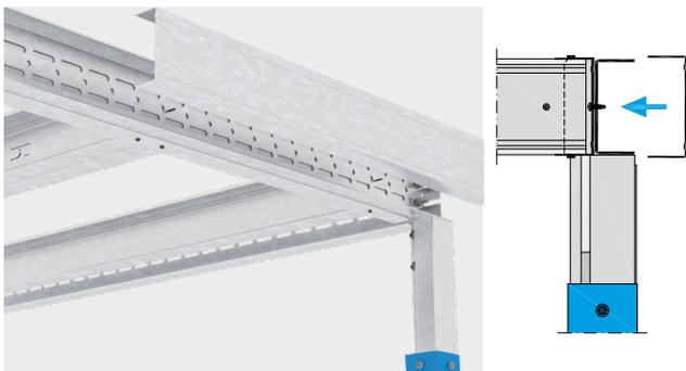
2. Obere UW-Anschlussprofile mit Blechschrauben LB 3,5 x 9,5 von unten mit Steg nach oben an die UA-Randprofile der Tragkonstruktion schrauben, Befestigungsabstand  $\leq 500$  mm. Bei der Verschraubung gehen wir davon aus, dass die Bleche aufeinanderliegen, **ohne Abstand**.
