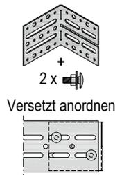
2. Erste und letztes UA-Einfachprofil im Abstand  $\leq 100$  mm von der Unterkonstruktionsinnenkante zur Mitte UA-Einfachprofil ausrichten und mit dem UA-Randprofilen der Tragkonstruktion mit 2 Flachrundschrauben M8 befestigen.
