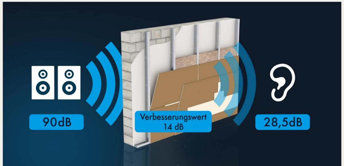
Durch Einsatz einer Vorsatzschale W626 vor der Massivwand kann zum Beispiel eine Verbesserung von 14 dB erzielt werden.
