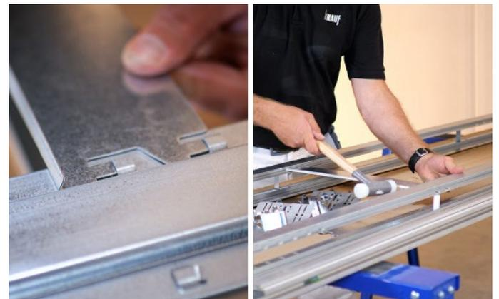
5. Montieren Sie die beiliegenden Distanzstücke in der passenden Höhe, siehe [Bild 10](#).
