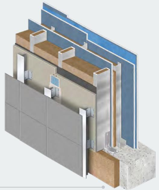
KAW eingestellte Doppelständerkonstruktion
