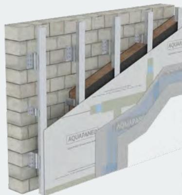
VHF mit Metallunterkonstruktion
