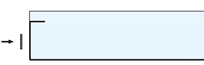
5. Aufschäumendes Dichtungsband an Längsseite Deckenelement aufkleben. Anschließend Deckenelement einhängen und auflegen. Das Mindestauflager ist stets einzuhalten.
