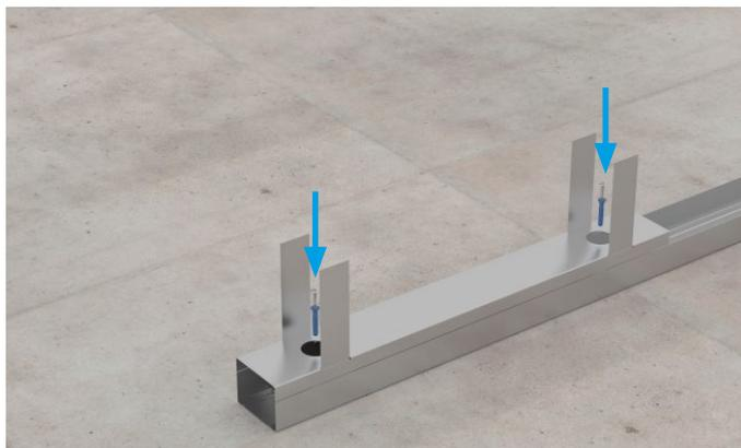
Bild 4: Höhe festlegen und Höhenausgleich durch vercrimpen oder seitlich bauseitigen Flachkopfschrauben befestigen
