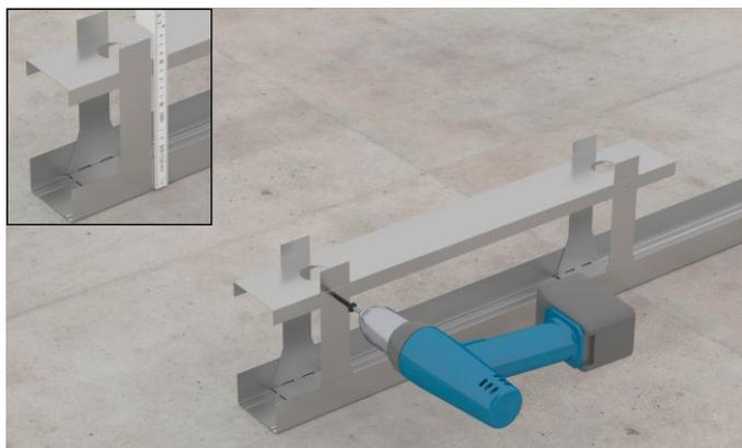
Bild 5: UW-Profil auf Pocket Kit Höhenausgleich auflegen und ausrichten
