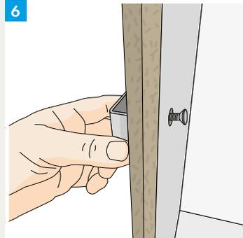
Die Spannklammern **D** werden zunächst nur an den senkrechten Bauteilen mittels der Schrauben **E** angebracht. Die Anzahl der benötigten Klammern ergibt sich durch die Anzahl der hierfür vorhandenen Lochbohrungen. Die Schrauben werden zunächst nur 1-2 Gewindegänge durch die Klammern geschraubt.
