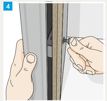
**4** Die Klammer mit Hilfe der Schraube in das Profil eindrücken. Das Profil gleichzeitig dagegendrücken.
