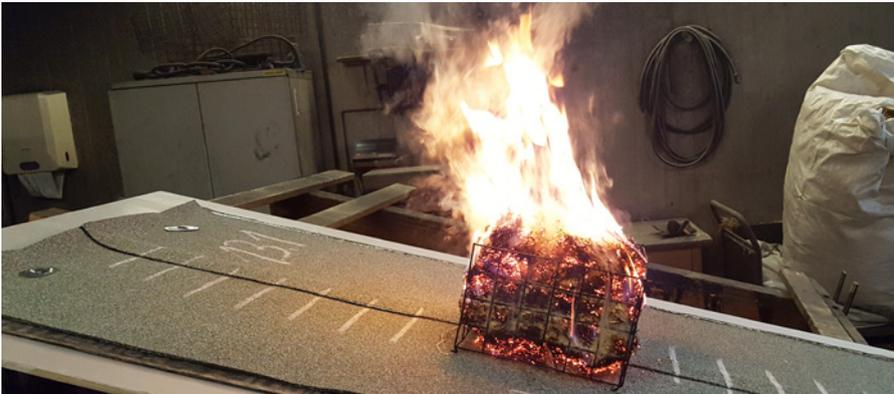
Folgende Dachbahntypen wurden bei der Materialprüfungsanstalt der Universität Stuttgart für die Nachweiserbringung der Anforderungen der „Harten Bedachung“ bezüglich der Beanspruchung von Bedachungen durch Feuer von außen B roof (t1) gemäß DIN CEN/TS 1187 erfolgreich geprüft:
