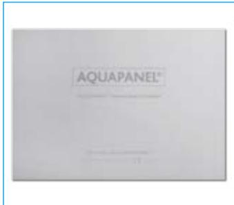
AQUAPANEL® Cement Board Outdoor ist die ideale Putz-trägerplatte und für viele Oberflächenbeschichtungen, z. B. Putz- und keramische Beläge, geeignet. Sie ermöglicht Biegeradien ab 1 m. Die Bauplatte besteht im Kern aus Portlandzement und Zuschlagstoffen und ist beidseitig mit einem Glasgittergewebe armiert.
