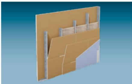
**W113.de Metallständerwand – Einfachständerwerk – Dreilagig beplankt**, z. B. W113.de, 2x 12,5 mm Silentboard + 12,5 mm Diamant
