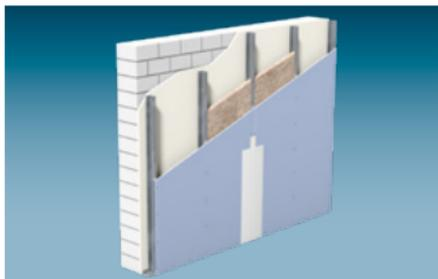
**W625.de Vorsatzschale freistehend – Metallständer CW – Einlagig beplankt, z. B. W625.de, 12,5 mm Diamant**
