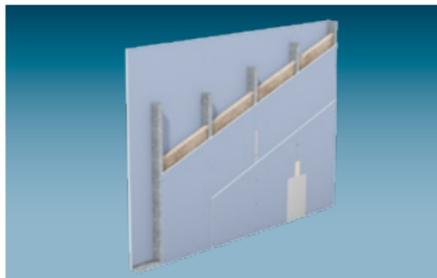
**W112.de Metallständerwand – Einfachständerwerk – Zweilagig beplankt**, z. B. W112.de, 2x 12,5 mm Diamant
