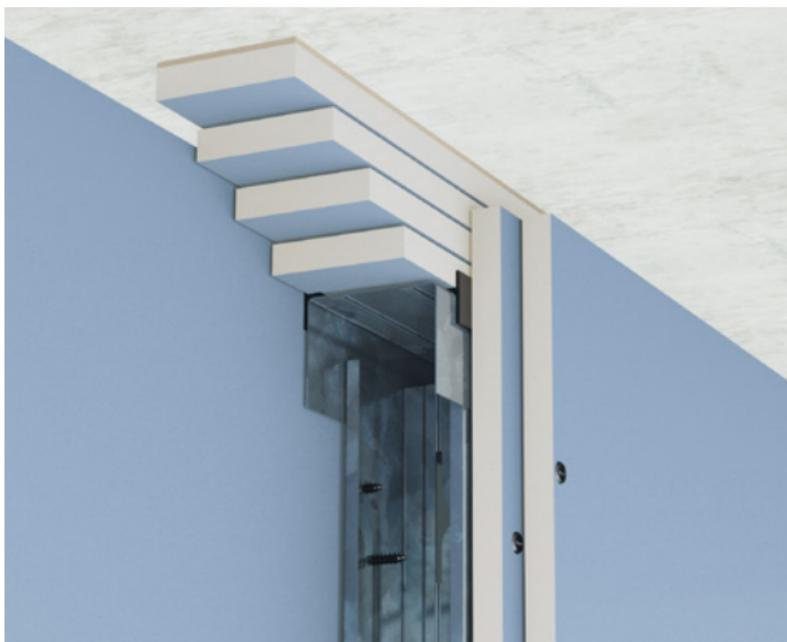
Je nach Schalldämm-Maß der Grundwand haben gleitende Deckenanschlüsse unterschiedlich hohe Einflüsse auf das resultierende Schalldämm-Maß. Bei der Ausführung von gleitenden Deckenanschlüssen ist immer auf eine fachgerechte Ausführung (entsprechend Detailblatt W11.de) zu achten. Undichtigkeiten zwischen den Plattenstreifen und der Rohdecke, an den Stößen zwischen den Plattenstreifen sowie der Beplankungslagen und dem Plattenstreifen mindern das zu erreichende Schalldämm-Maß erheblich.
