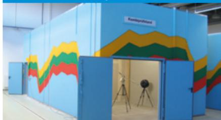
Im Kombiprüfstand können die Konstruktionsdetails der Übergänge von Unterdecke zu Trennwand getestet werden. Die Schallübertragung wird zum großen Teil von der Gestaltung der Verbindung mit der Trennwand bestimmt.
