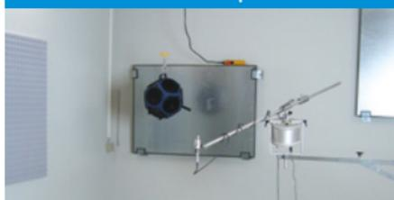
Hier wird die Messung der Luft- und Trittschalldämmung von Holzbalkendecken durchgeführt. In diesem Prüfstand können alle Bestandteile einer Decke frei variiert werden, z. B. Estrich, Trittschalldämmung, Fußbodenheizung, Balkenquerschnitt, Hohlraumdämmung, Abhängesysteme oder Beplankung.
