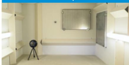
In diesem Prüfstand wird an der genormten Bezugsdecke aus 140 mm Stahlbeton die Verbesserung von Luft- und Trittschalldämmung durch Unterdecken geprüft.
