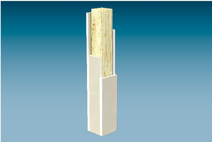
Das System **K255.de** Knauf Fireboard Holzstützen-Bekleidung wird ohne Unterkonstruktion ausgeführt. Die Befestigung der Bekleidung erfolgt durch stirnseitiges Verklammern in die Fireboard.
