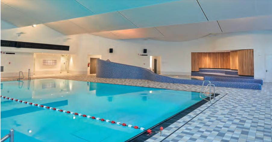
Für das Familienbad Ohlsdorf wählten die Trockenbauer Konstruktionen mit AQUAPANEL® Cement Board Indoor – insgesamt wurden 1.200 m<sup>2</sup> Platten im Wand- und Deckenbereich der Duschen, der Umkleiden und der großen Schwimmhalle verarbeitet.
