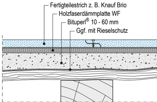
**Mehrlagiger Trockenestrich Aufbau über Holzbalkendecke mit Bituperl® und Brio + Vidiwall für erhöhte Lastaufnahme**
