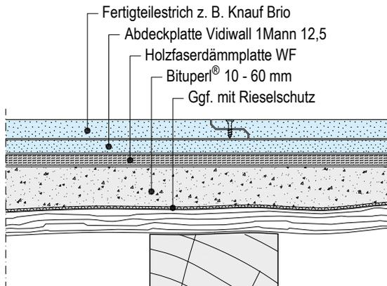
**Ausgleich mit Bituperl auf tragfähigen Fehlboden**
