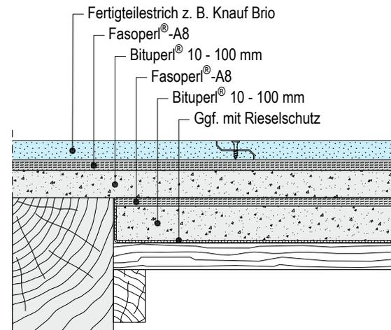
**Estrich-Aufbau über Betondecke**
