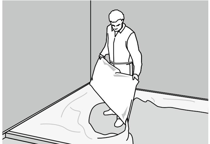
Estroperl® wird zwischen zwei Hilfsstreifen geschüttet und mit Abziehlehren oder einer Richtlatte eben abgezogen. Die Mindestschütthöhe von 10 mm (auch über Unebenheiten oder Rohrleitungen) ist zu beachten. Um unerwünschte Verdichtung zu vermeiden, darf die Schüttung nicht betreten werden.
