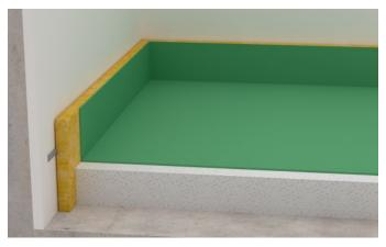
Bei Fließestrich oder anderen Mörtelestrichen Dämmschichtabdeckung (z. B. Knauf Schrenzlage) am Rand über Randdämmstreifen Mineralwolle senkrecht hochziehen und gegen Umklappen sichern, damit keine Feuchtigkeit oder Mörtel in den Randdämmstreifen Mineralwolle oder Zwischenräumen dringen kann.
