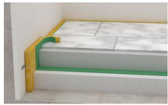
Erst wenn der Oberbelag verlegt ist, den überstehenden Teil des Randdämmstreifen Mineralwolle abschneiden (gemäß DIN 18560-2).
